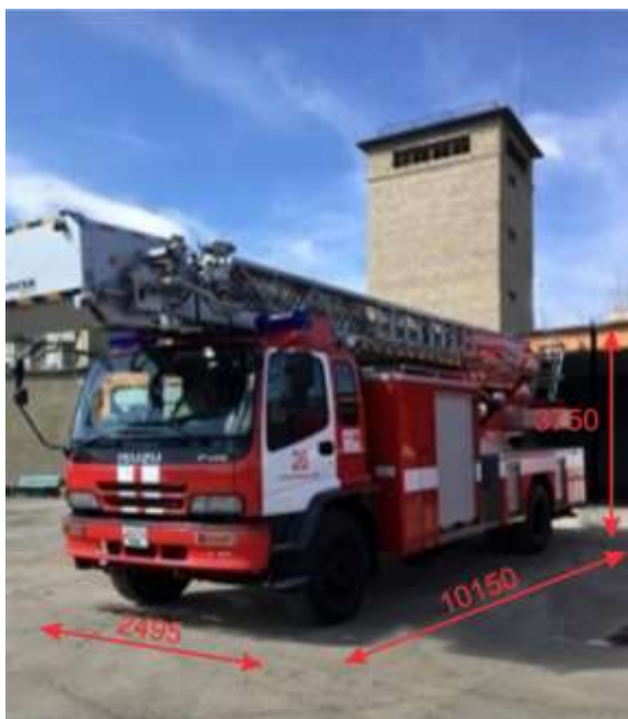
Зураг 3. ISUZU маркийн шатны машины техникийн үзүүлэлт
