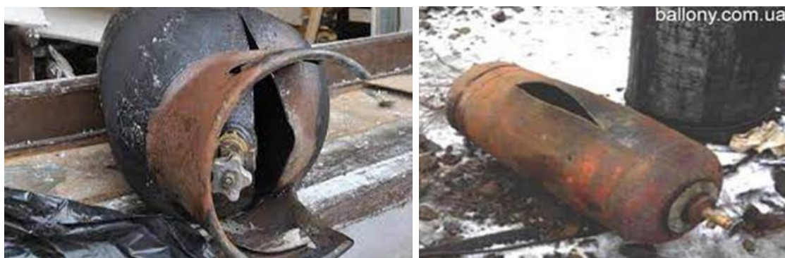
Зураг 4. Баллоны дэлбэрсэн байдал
